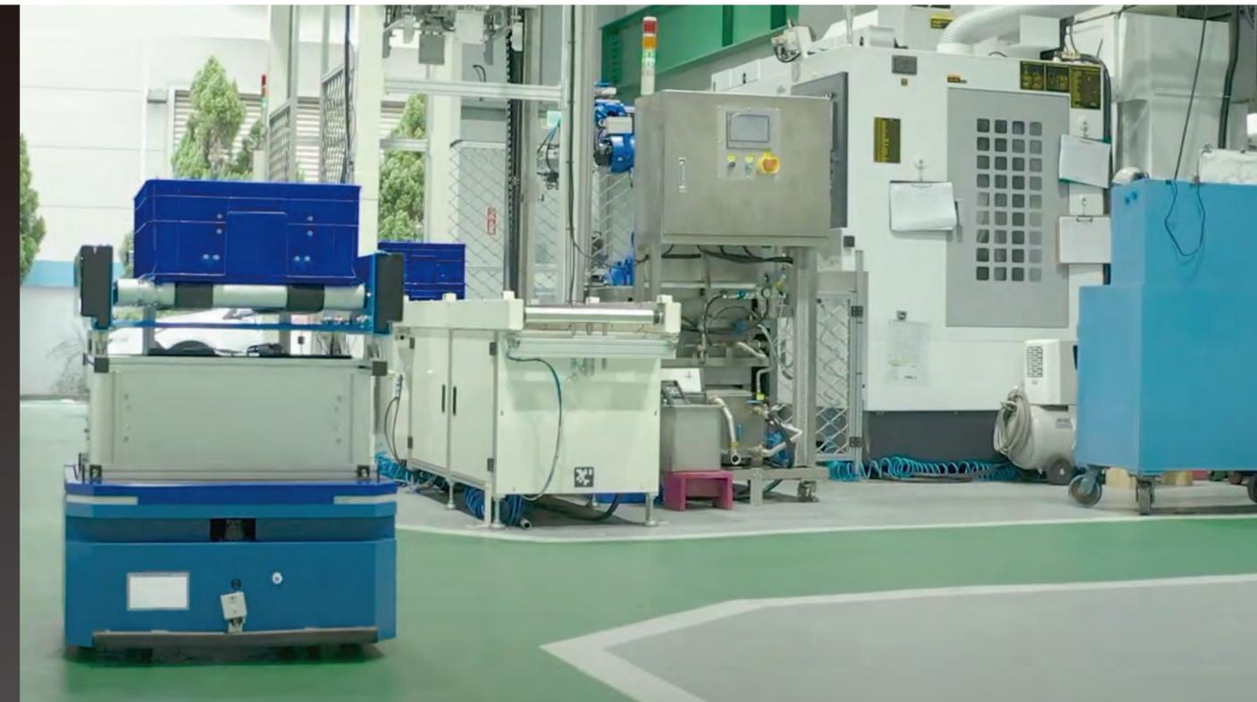
產線設備運作監測中心透過5G專網結合DDS能即時整合產線資訊，串連AMR自主移動機器人運送零組件至各檢測部門，提高生產效能！
