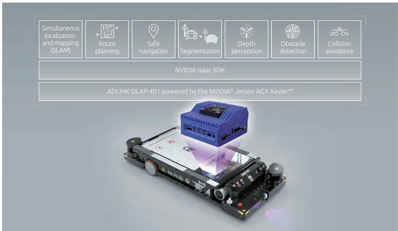
図2. ADLINKのDLAP-401は、NVIDIA® Jetson AGX Xavier™システムオンモジュールを搭載し、非常に高いレベルのコンピューティング性能を実現します。
